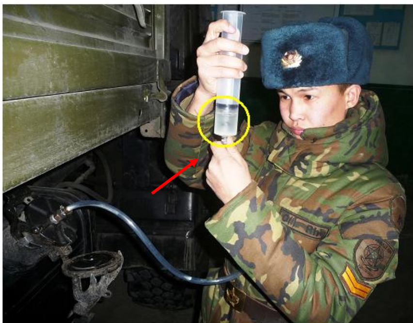
Рис. 4 Контроль герметичности топливной системы двигателя автомобиля КАМАЗ с помощью воздушно-жидкостного индикатора
