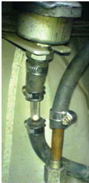
Рис. 4. Устройство обнаружения и контроля герметичности системы питания топливом двигателя бронетранспортёра БТР-80.
