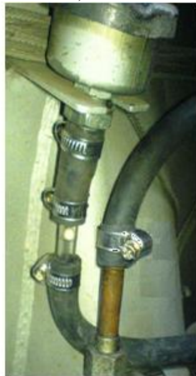
Рис. 4. Устройство обнаружения и контроля герметичности системы питания топливом двигателя бронетранспортёра БТР-80.
