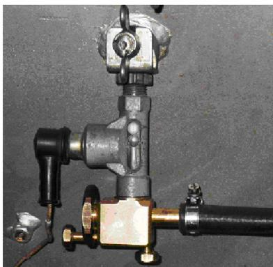
Рис. 3в. Устройство в положении контроля избыточного давления внутри обитаемых отделений.
