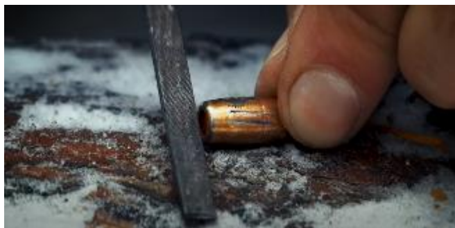
Рис. 3 – Медь не остается в гранях инструмента
