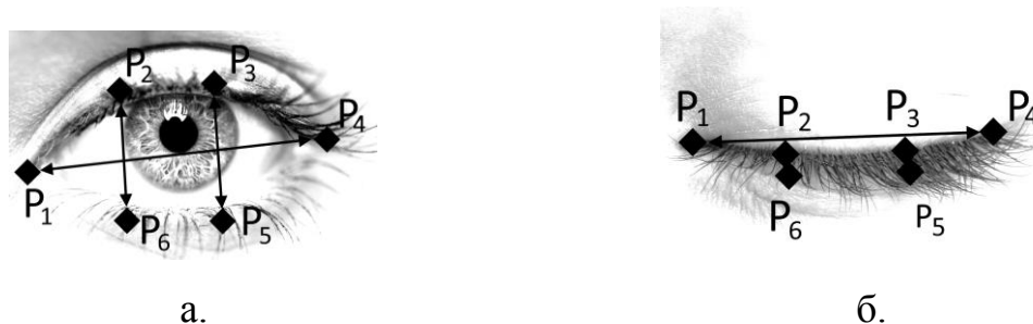
Рисунок 2 – Реперные точки для расчета метрики \overline{EAR} : а. глаз открыт; б. глаз закрыт
